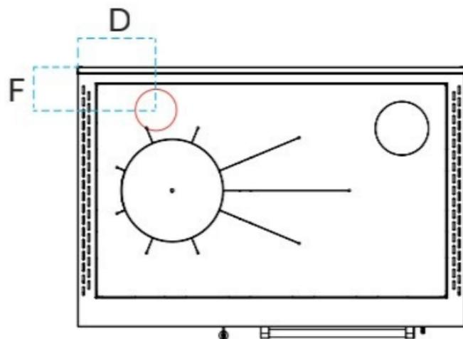
\* Holzherde mit Rauchausgang links sind symmetrisch. Die externe Frischluftzufuhr befindet sich immer auf der Seite der Brennkammer.
